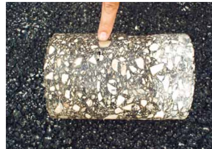
Obr. 4 Sieť RoadMesh neoddeľuje vrstvy vozovky
