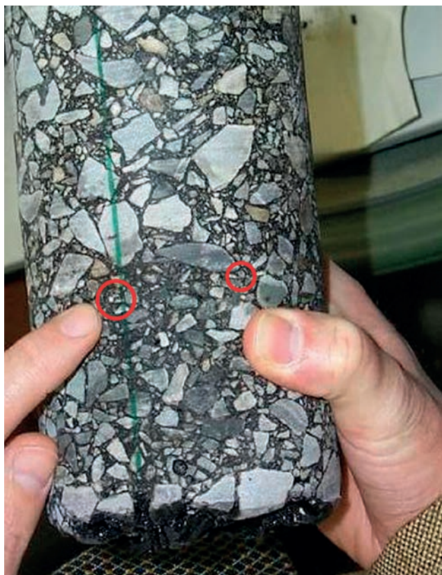
Vývrt z vozovky, kde bola inštalovaná sieť RoadMesh®, dokumentuje 3D štruktúru siete a jej prepojenie s vrstvou asfaltového krytu bez vytvorenia deliacej vrstvy.
