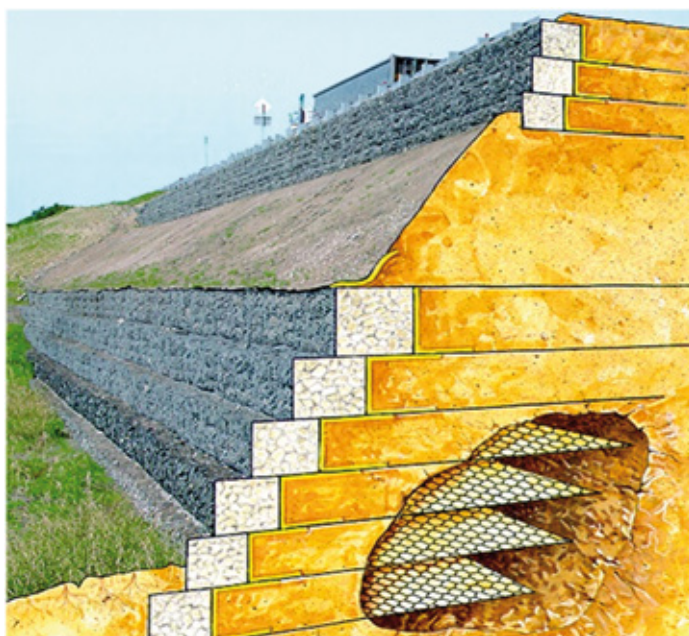
Рис. 1 Устройство армированной «Системы Террамеш»®
