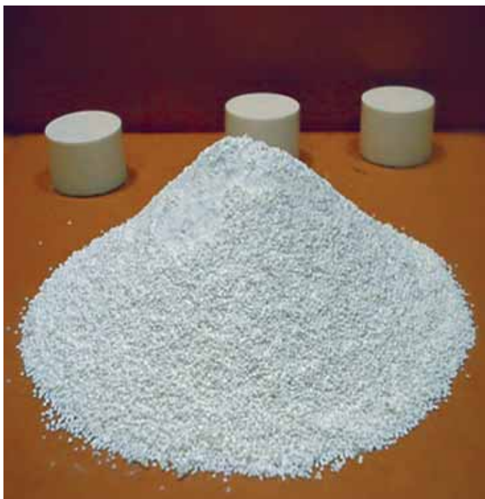
Рис. 5. Лабораторные тесты материала Groutmaster
