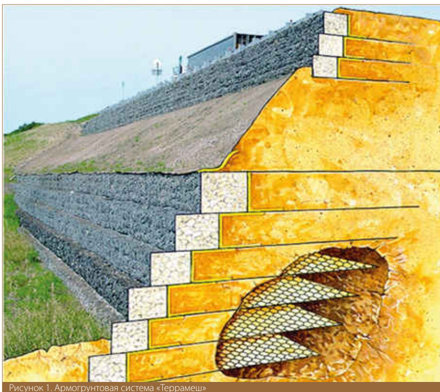
Рисунок 1. Армогрунтовая система «Террамеш»
