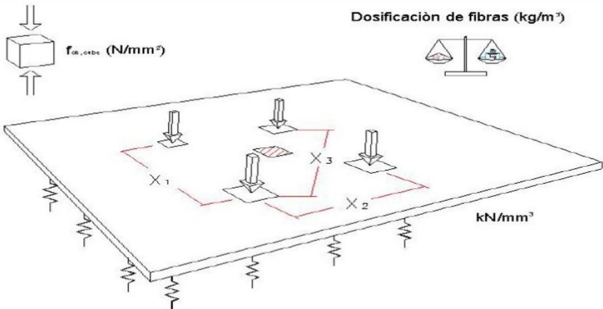
Esquema de diseño de cargas en el software PAVE<sup>®</sup> de Maccaferri.
