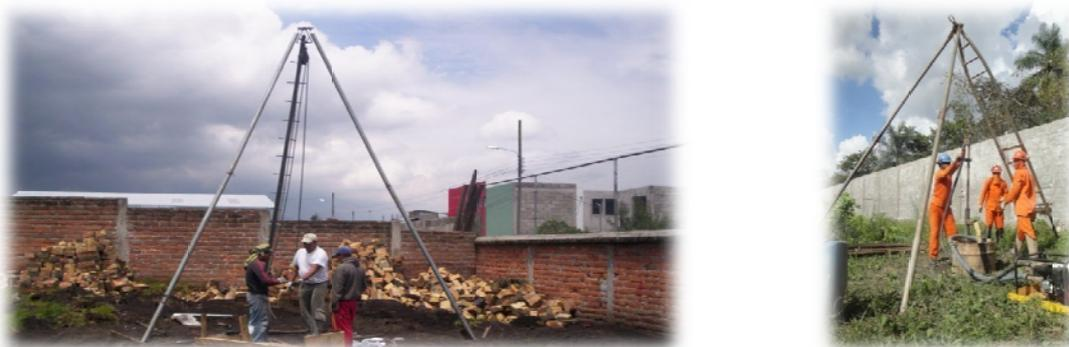
Figura 14. Ensaio de SPT
