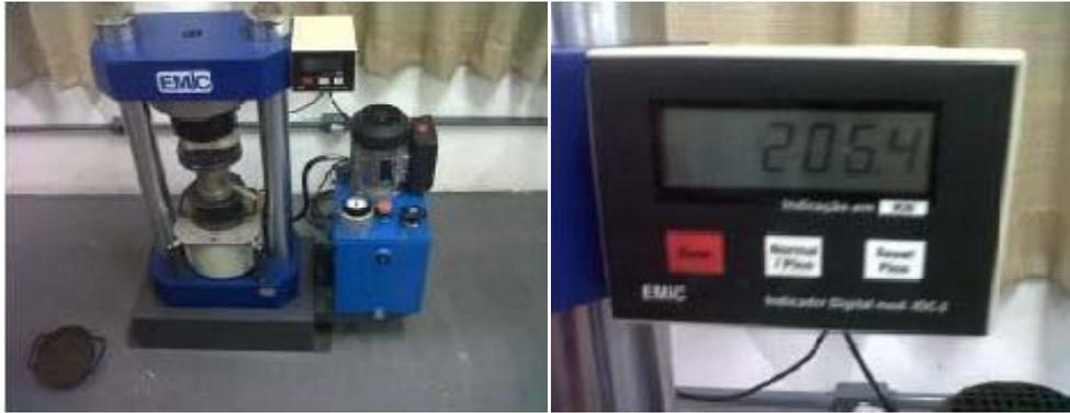
Figura 23. Ensaio de compressão do RCD
