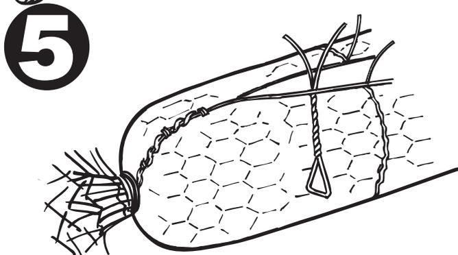
Coloque tirantes diametrais ou perimetrais a cada metro para evitar deformações excessivas durante o enchimento e lançamento.
