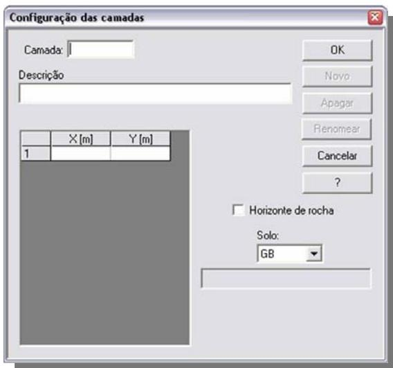
Clicando sobre a opção *Geometria das camadas* é possível inserir a estratigrafia do solo local através de coordenadas cartesianas. E quantas forem necessárias.
